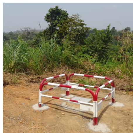
Exemple de borne géodésique installée sur le site du projet - 23/12/21
